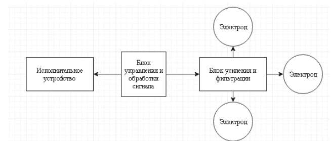
Рис. 8. Схема управления протезом стопы
